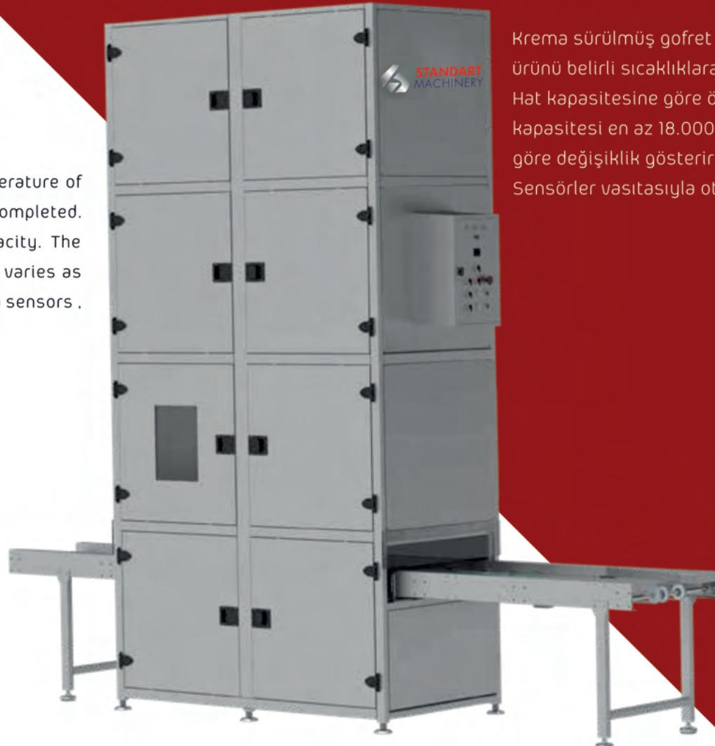
Krema sürülmüş gofret bloklarını soğutma sistemleriyle ürünü belirli sıcaklıklara düşürmek için kullanılan soğutucudur. Hat kapasitesine göre özel olarak ayarlanabilir. Soğutma kapasitesi en az 18.000 kcal/h den başlayarak kapasitesine göre değişiklik gösterir. Sistem dur kalk şeklinde çalışır. Sensörler vasıtasıyla otomatik boşaltma mevcuttur.
